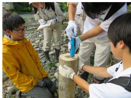
マーキング箇所で針貫入試験を行う様子
