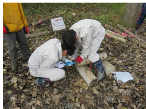
硬度計の貫入試験の様子
