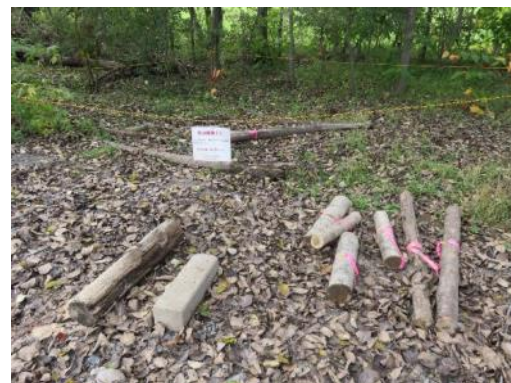
土中から掘り出した試験材
