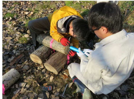
硬度計の貫入試験の様子
