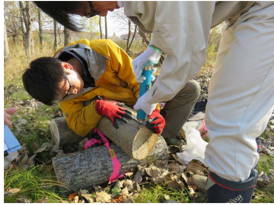
硬度計の貫入試験の様子
