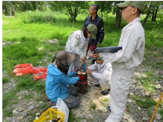
硬度計の貫入試験の様子
