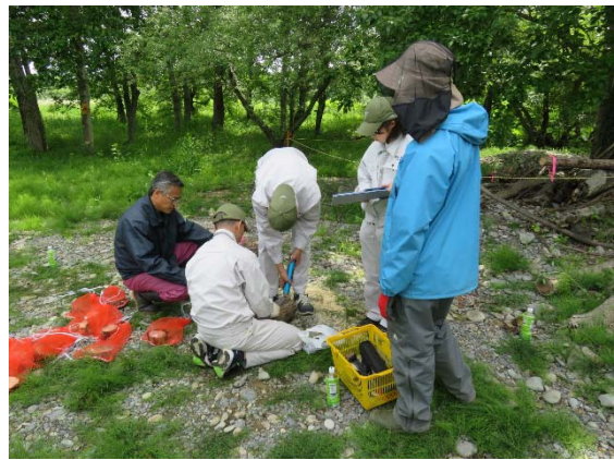
硬度計の貫入試験の様子
