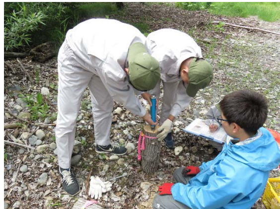
硬度計の貫入試験の様子
