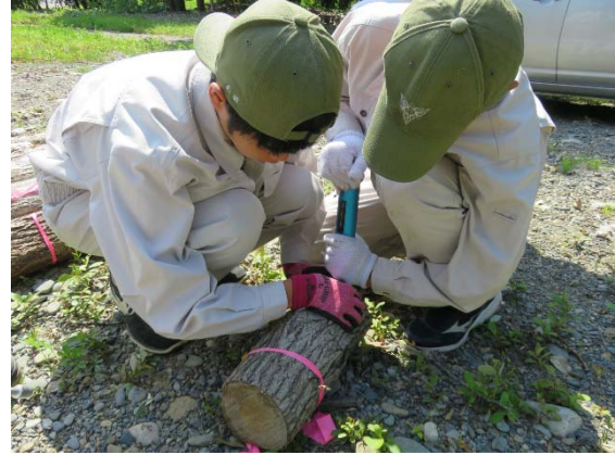
硬度計の貫入試験の様子
