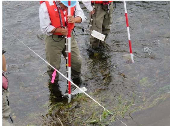
低水流量観測の様子（左：ポールによる水深測定／右：回転式流速計による測定）
