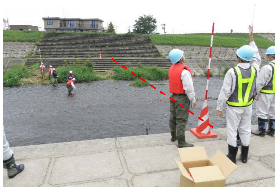
浮子による流速観測基線（上流側）
