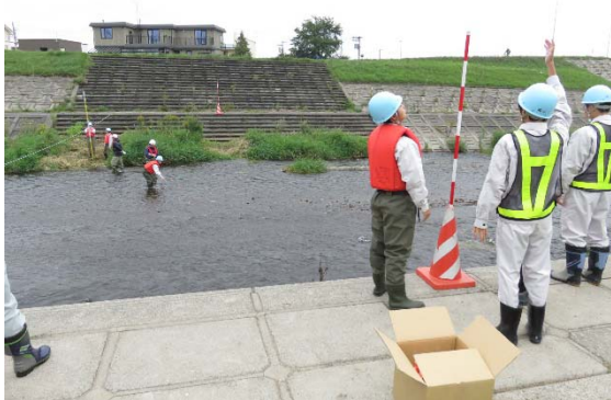
浮子による流速測定の様子
