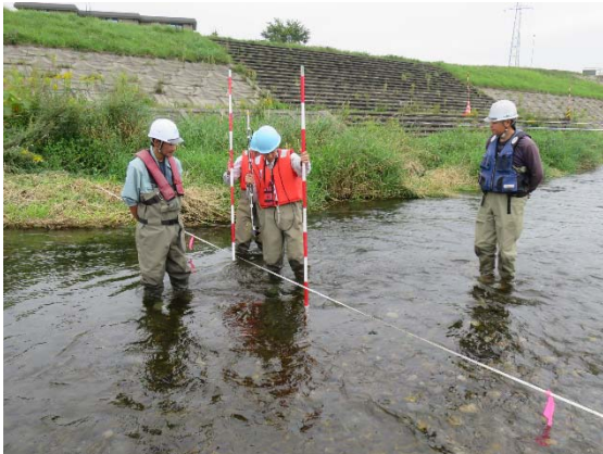
低水流量観測の様子（左：ポールによる水深測定／右：回転式流速計による測定）
