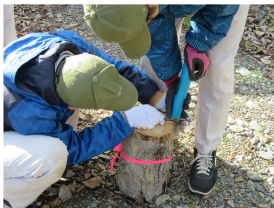
硬度計の貫入試験の様子
