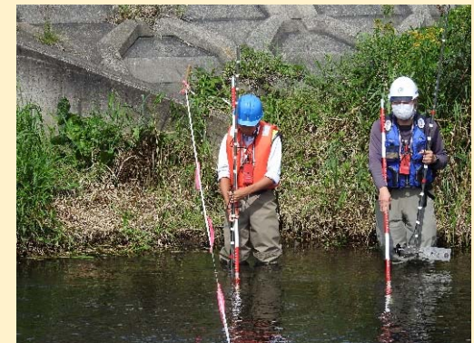
水深及び流速の計測状況
