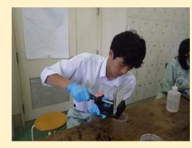
調査地に存置している試料木から木片を切り出し、室内で細かく砕き50g(木質の重量)分を採取し、5倍 (250cc)の水道水に一昼夜浸漬し、現地確認後に帯広工業高校に移動して水素イオン指数(pH)及び電気伝導率(EC)を計測しました。
