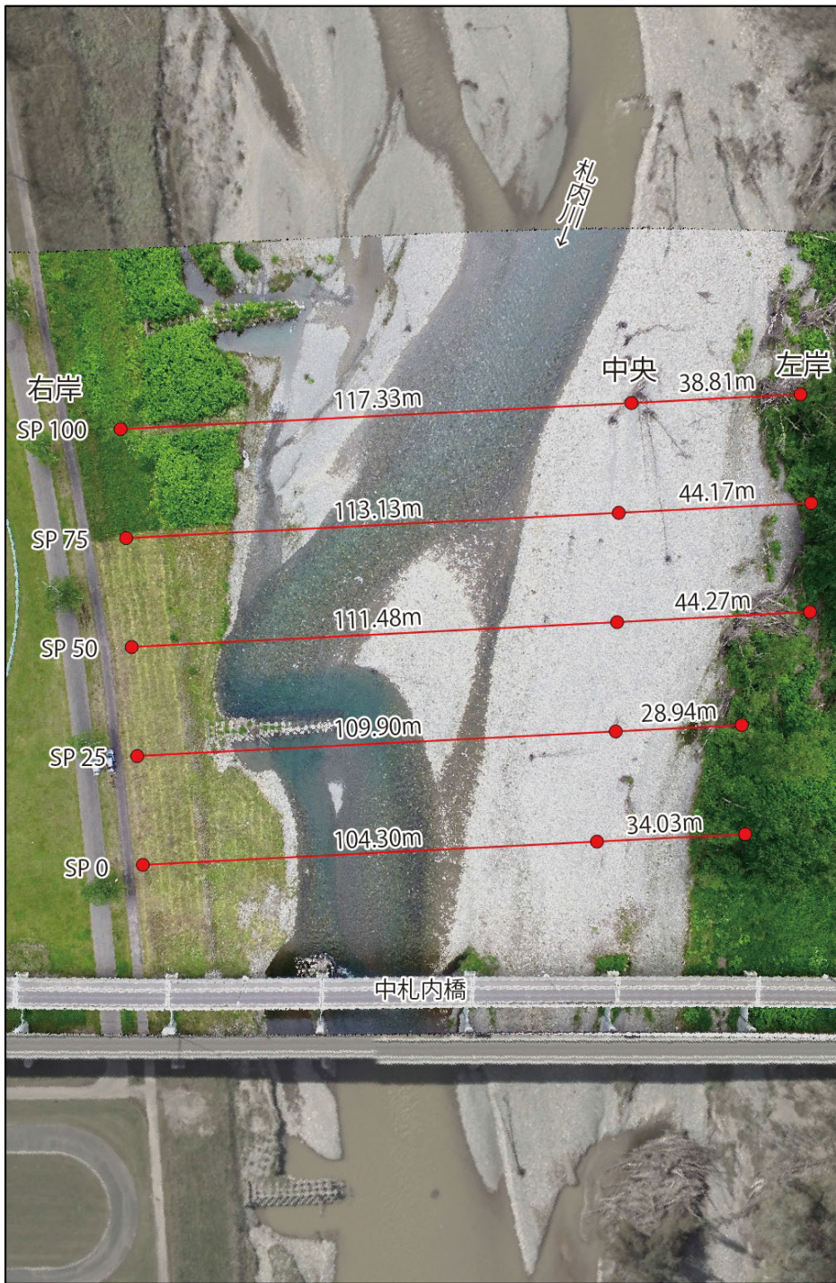
横断測量箇所
