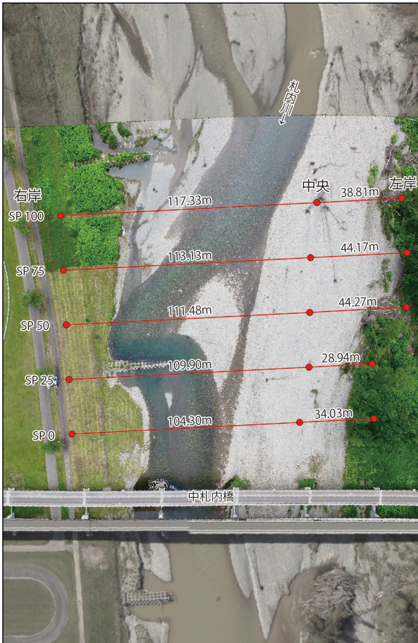
横断測量箇所
