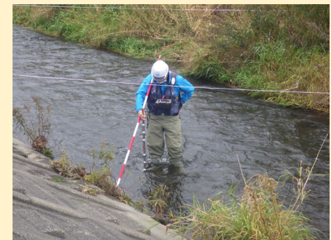
水深及び流速の計測状況
