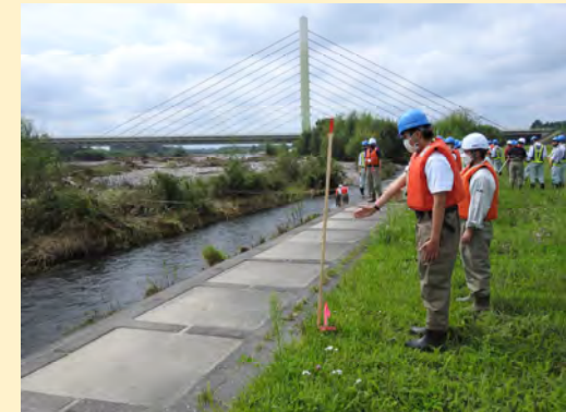
浮子の流速測定状況
