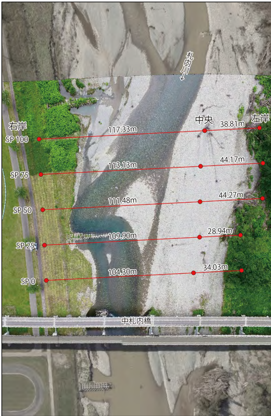
横断測量箇所
