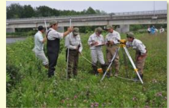
高水敷の横断測量
