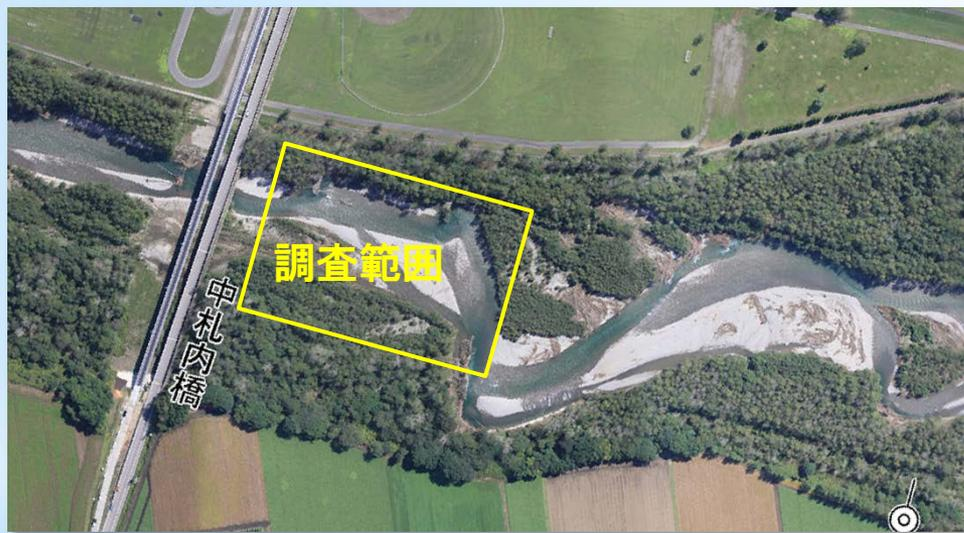
●**目的**：札内川ダム放流に伴う礫河原の**地形的変化**及び**植生的変化**を経年的に調査し、ダム放流に伴う河道、特に礫河原への影響について検証する。
