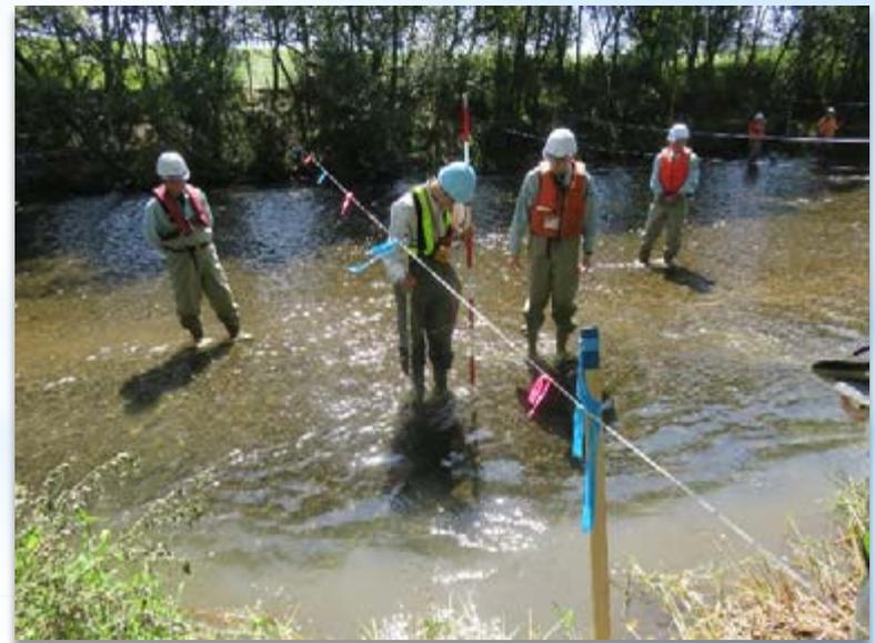
横断測量・水深・流速の計測とHQ式
