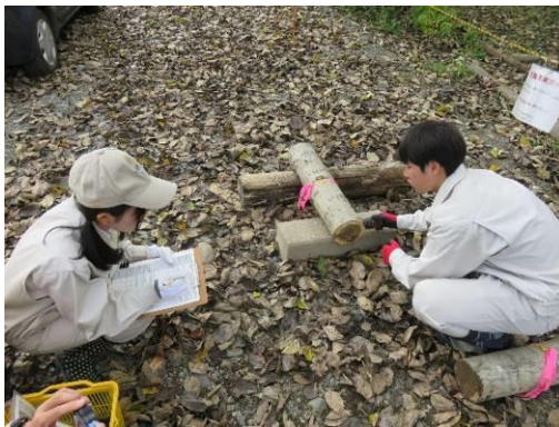
水分量の計測と記録する様子
