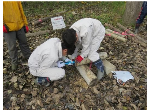
硬度計の貫入試験の様子
