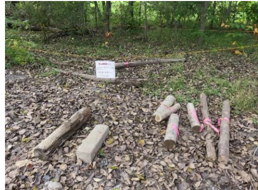
土中から掘り出した試験材
