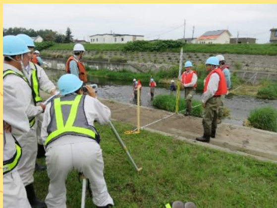
横断測量の状況
