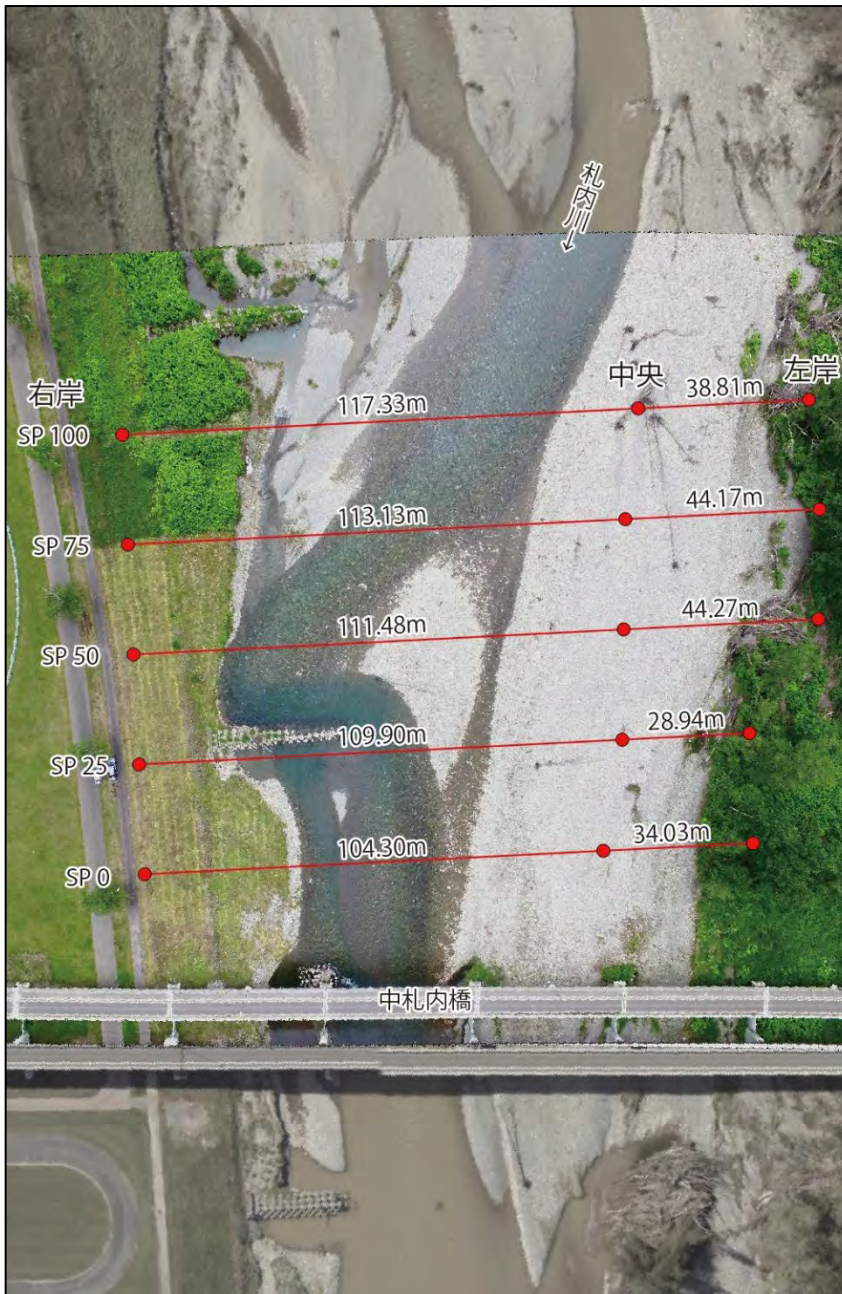
横断測量箇所
