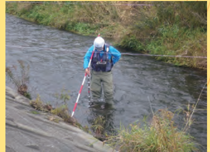
回転式流速計による測定の様子
