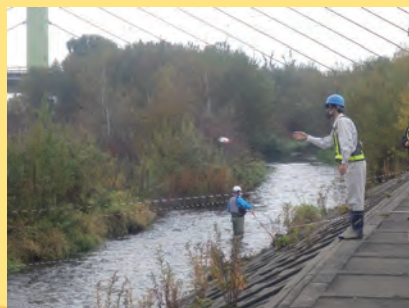
浮子による流速測定
