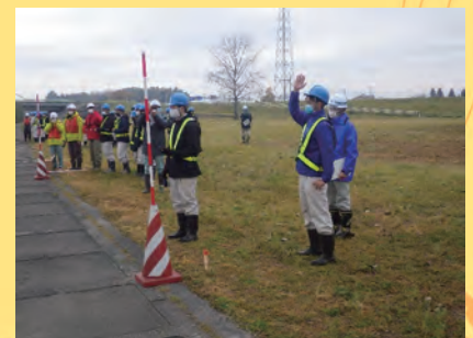
浮子による流速測定
