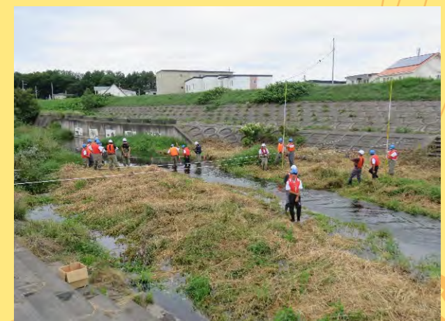
浮子による流速測定
