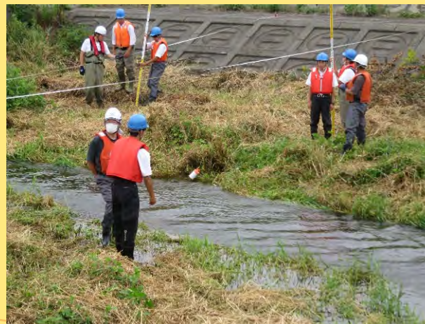
浮子による流速測定
