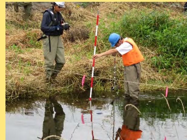
回転式流速計による測定の様子
