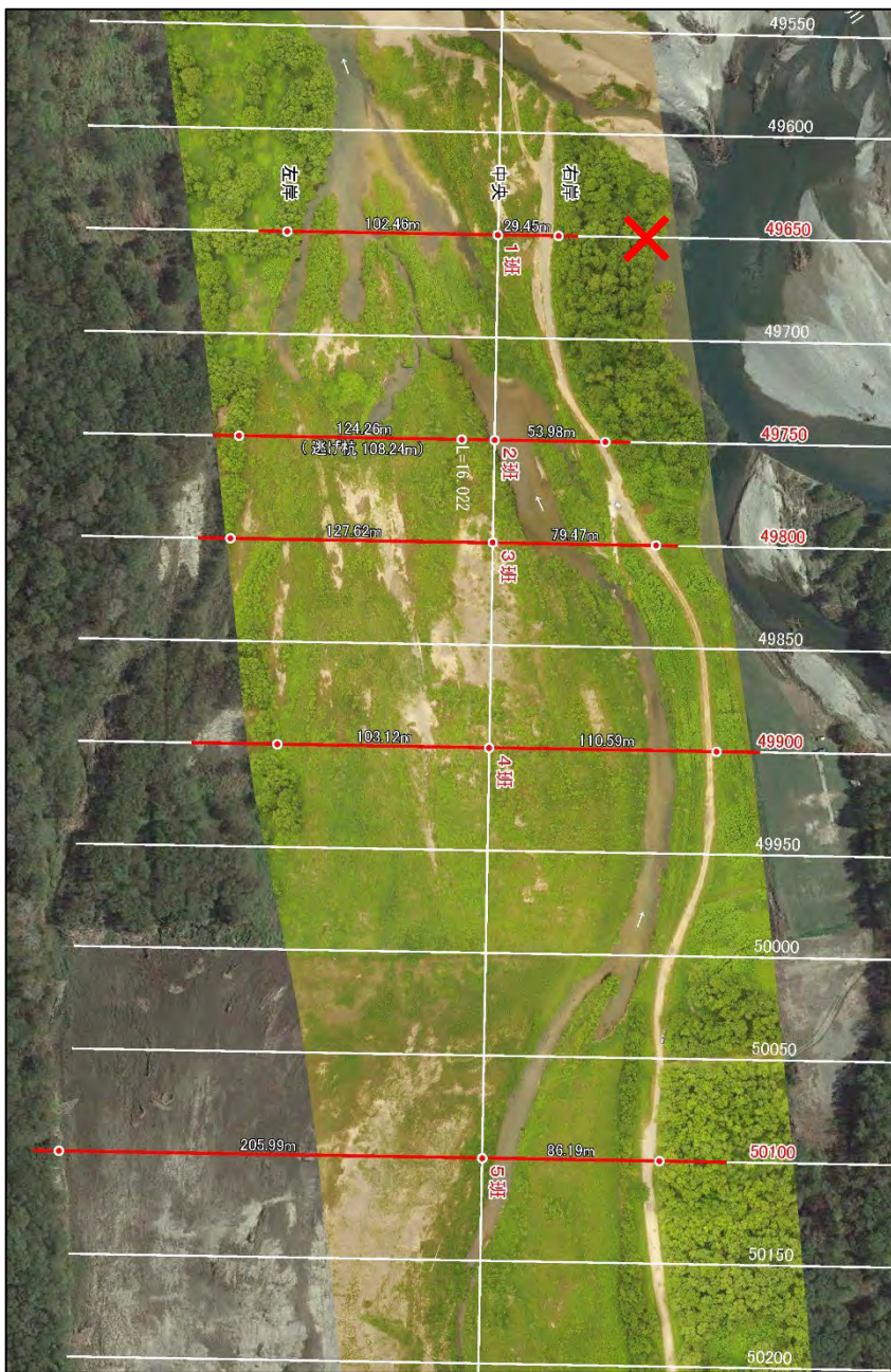
横断測量箇所
