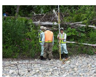
6 月 27 日 帯広工業高校 1 年生 中札内橋上流の河川横断測量
